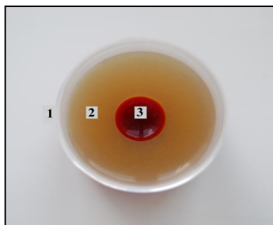
Рисунок 2. Фотография стакана с заполненным контрастной массой каналом (вид сверху). 1 – стенки стакана; 2 – агар-агар; 3 – канал.
