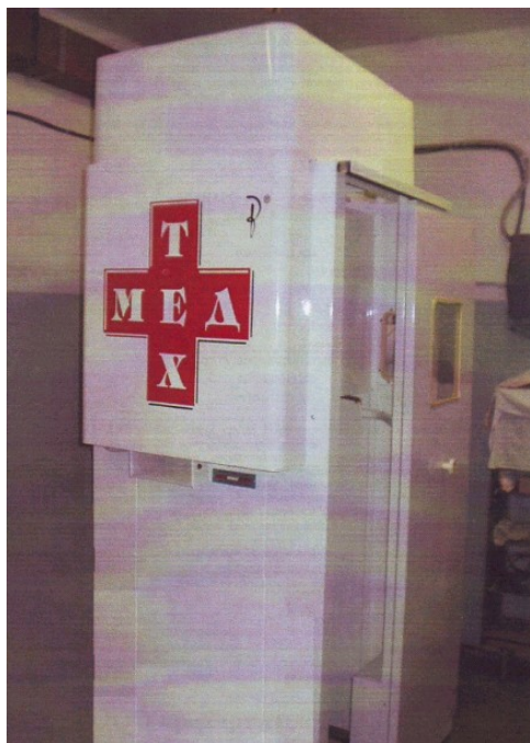
Рис. 3. Флюорографический аппарат с цифровой приставкой сканирующего типа.
